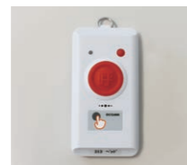
緊急通報装置(2箇所)
